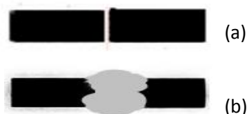
Imagem 1: (a) Chanfro em "I"; (b) Junta de topo em duplo "I".
